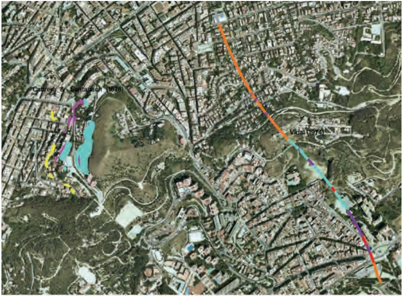
Figura 6: Georeferenciació de les observacions d'afloraments del treball de Cabrera & Santanach (1978) entre la Creueta del Coll i el Turó del Carmel i de les observacions realitzades a la galeria d'avanç del Túnel de la Rovira a cota 100 metres per damunt del nivell de la mar per Vidal (1974).
